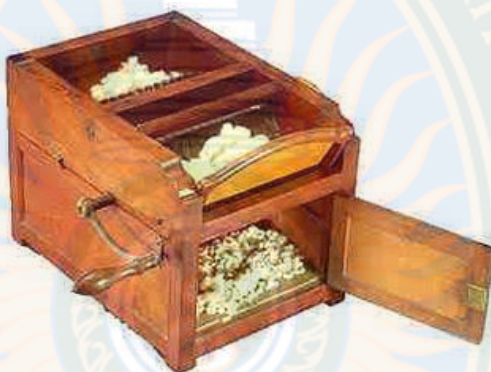
ภาพที่ 6 เครื่องทียบฝ้ายชนิดฟันเลื่อย ที่มา : พิพิธภัณฑสถานแห่งชาติ (2551)
