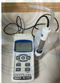
ภาพที่ 18 pH meter portable ที่ใช้ในงานวิจัย
