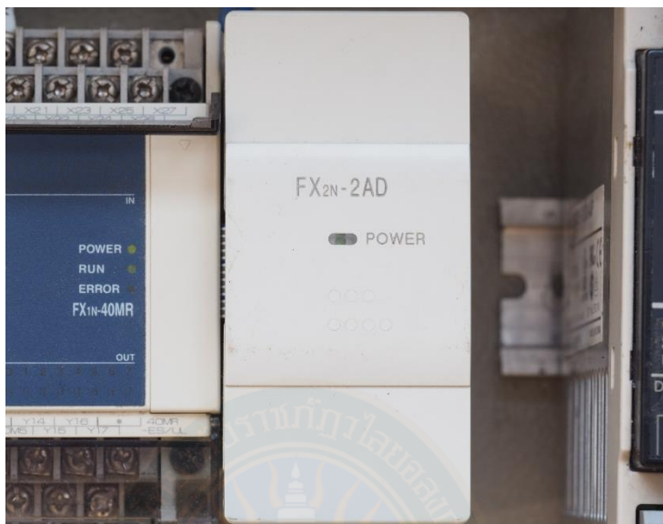
ภาพที่ 14 อุปกรณ์แปลงสัญญาณอนาล็อกเป็นสัญญาณดิจิทัล
