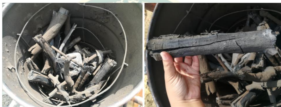
ภาพที่ 10 ถ่านชีวภาพหลังจากเผาแล้วมีลักษณะคงรูปร่างเดิม
