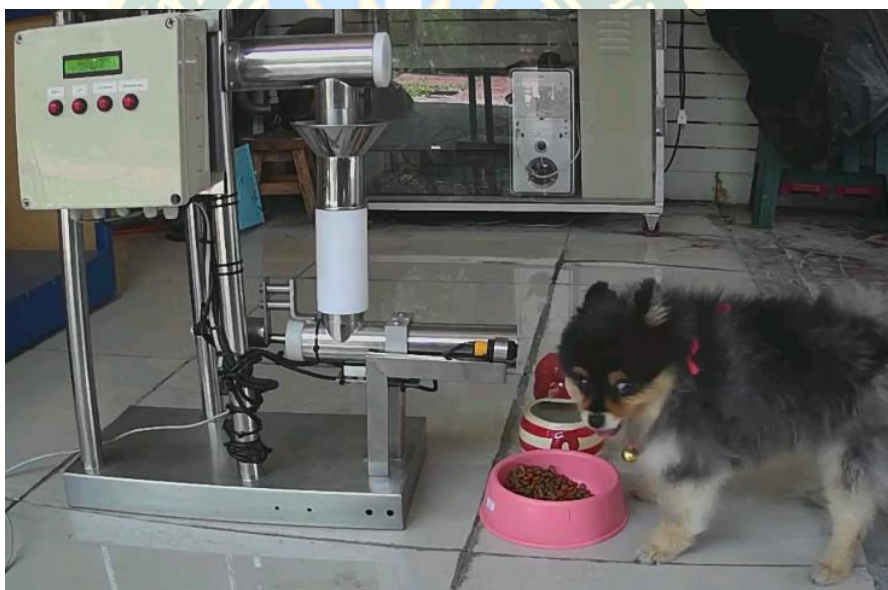
ภาพที่ 72 การทดลองระบบควบคุมการจ่ายอาหารตามช่วงเวลาของสุนัขพันธุ์ปอมเมอเรเนียน น้ำหนัก 7 กิโลกรัม โดยการตรวจจับการเคลื่อนไหว
