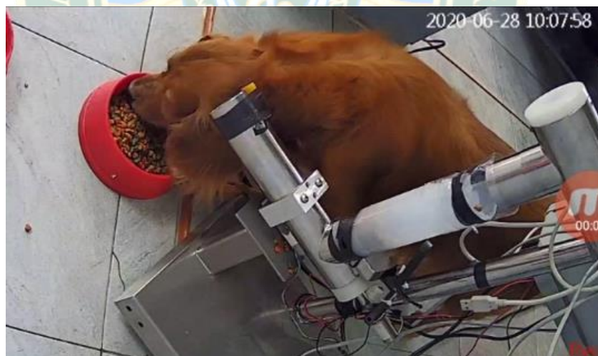
ภาพที่ 75 การทดลองระบบควบคุมการจ่ายอาหารตามช่วงเวลาของสุนัขพันธุ์ค็อกเกอร์สแปเนียล น้ำหนัก 12 กิโลกรัม โดยสุนัขกินอาหารจากเครื่องการส่งจ่ายอาหารอัตโนมัติ
