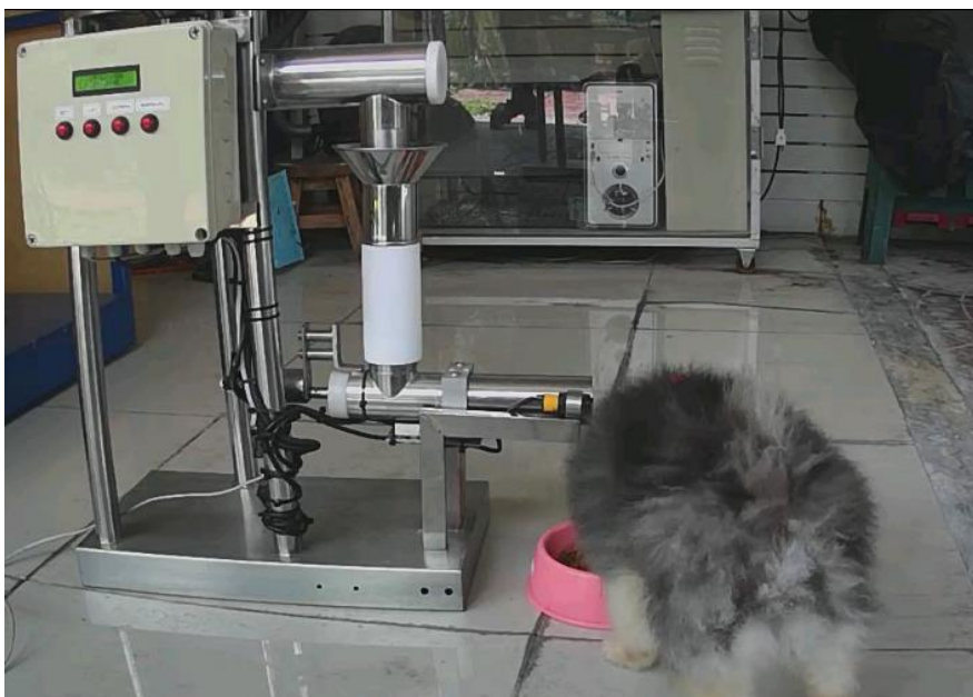
ภาพที่ 73 การทดลองระบบควบคุมการจ่ายอาหารตามช่วงเวลาของสุนัขพันธุ์ปอมเมอเรเนียน น้ำหนัก 7 กิโลกรัม โดยสุนัขกินอาหารจากเครื่องการส่งจ่ายอาหารอัตโนมัติ
