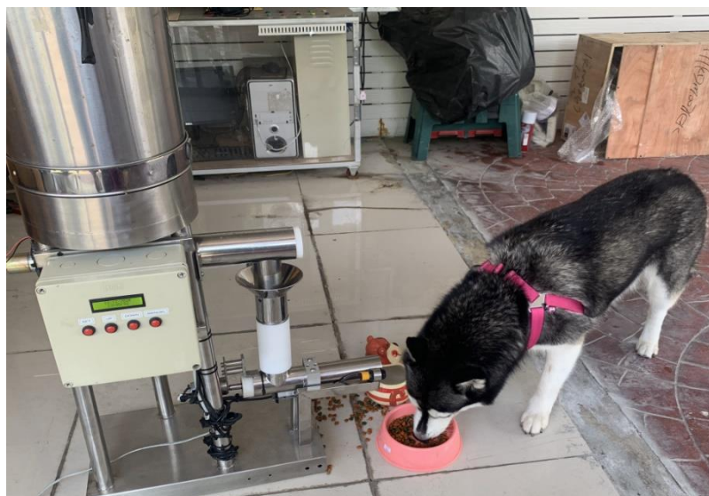
ภาพที่ 77 การทดลองระบบควบคุมการจ่ายอาหารตามช่วงเวลาของพันธุ์ไซบีเรียน ฮัสกี้ น้ำหนัก 22 กิโลกรัม โดยสุนัขกินอาหารจากเครื่องการส่งจ่ายอาหารอัตโนมัติ
