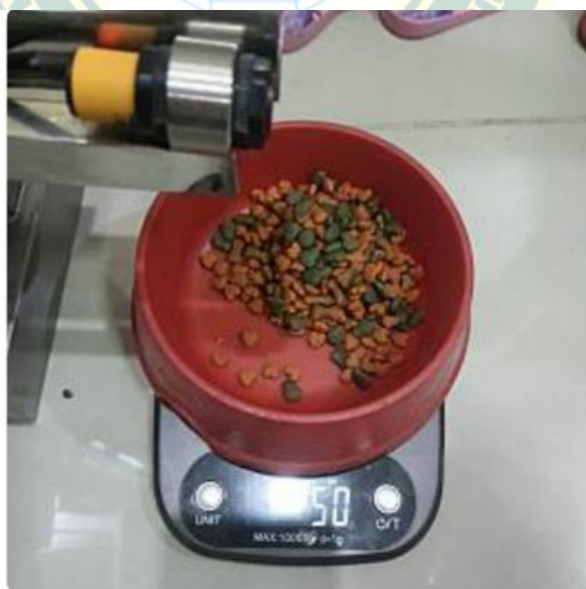
ภาพที่ 51 การทดสอบและวิเคราะห์ระบบการทำงาน (load cell หรือการชั่งตวง)
