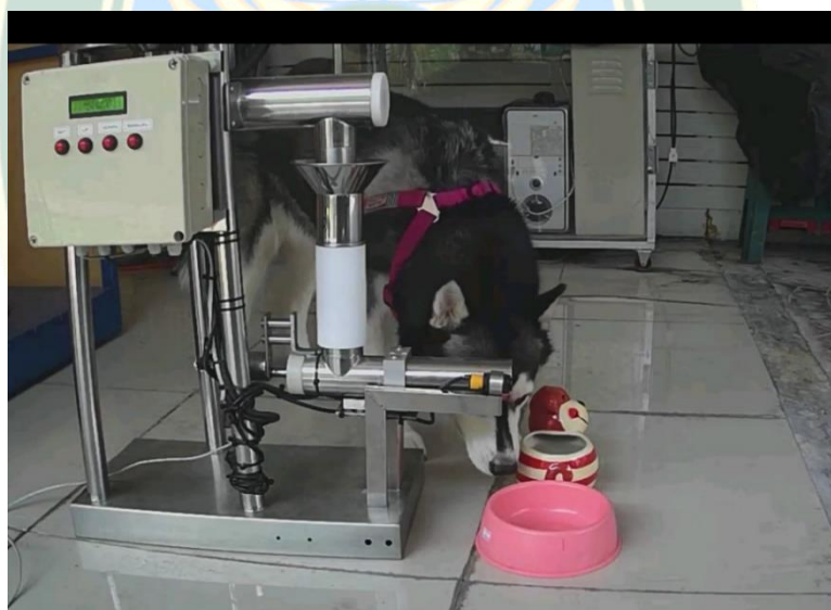
ภาพที่ 76 การทดลองระบบควบคุมการจ่ายอาหารตามช่วงเวลาของสุนัขพันธุ์ไซบีเรียน ฮัสกี้ น้ำหนัก 22 กิโลกรัม โดยการตรวจจับการเคลื่อนไหว
