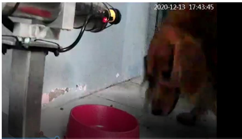
ภาพที่ 74 การทดลองระบบควบคุมการจ่ายอาหารตามช่วงเวลาของสุนัขพันธุ์ค็อกเกอร์สแปเนียล น้ำหนัก 12 กิโลกรัม โดยการตรวจจับการเคลื่อนไหว
