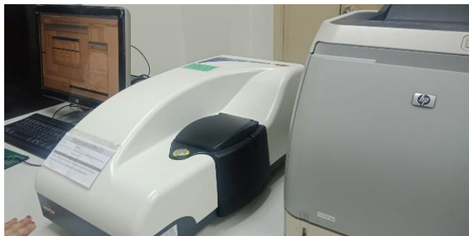
ภาพที่ 27 เครื่องวิเคราะห์หาขนาด และประจุอนุภาคชนิดสับไมครอน
