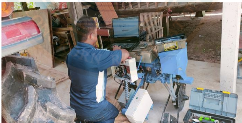
ภาพที่ 44 การประกอบงานไฟฟ้าและระบบควบคุม
