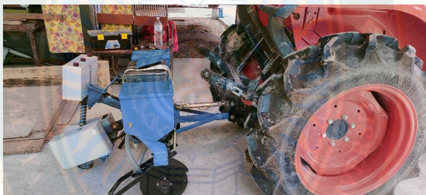
ภาพที่ 50 การประกอบเครื่องหยอดเมล็ดธัญพืชเข้ากับรถไถ
